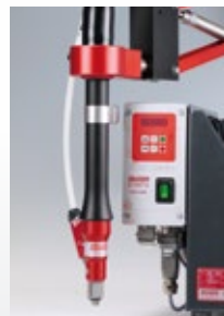
HSH + Integrierter pneumatischer Antrieb + Fest vorstehende Schraube + Automatischer Bitvorhub
