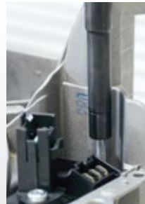
SEV + Mit Vakuumwerkzeug (für schwer zugängliche Schrauborte)
