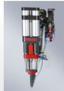
FSF + Für fließlochformende Schrauben
